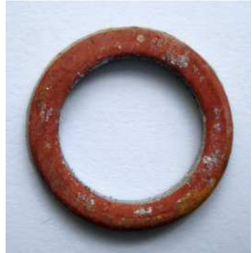
Asbesthaltiges Dichtungsring einer Öllampe
