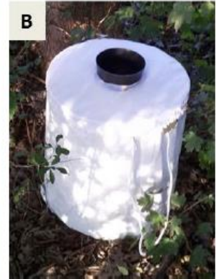
Biogents (BG) Sentinel-Falle für ausgewachsene Mücken, Quelle: SwissTPH
